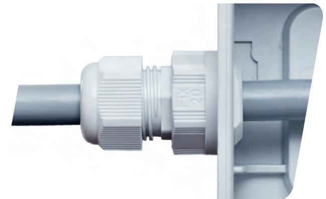
Die PERFECT Fix Kabelverschraubung ist die ideale Lösung zur Kabeldurchführung an schwer zugänglichen Stellen. Die Installation ist einfach von einer Seite her und ohne spezielle Werkzeuge zu bewältigen. Man benötigt auch kein Innengewinde und keine Gegenmutter. Durch Drehen der unteren Befestigungsmutter wird die PERFECT Fix Kabelverschraubung an der Gehäusebohrung festgezogen. Einsetzbar ist sie bei Wandstärken von 1 mm bis 4 mm.
