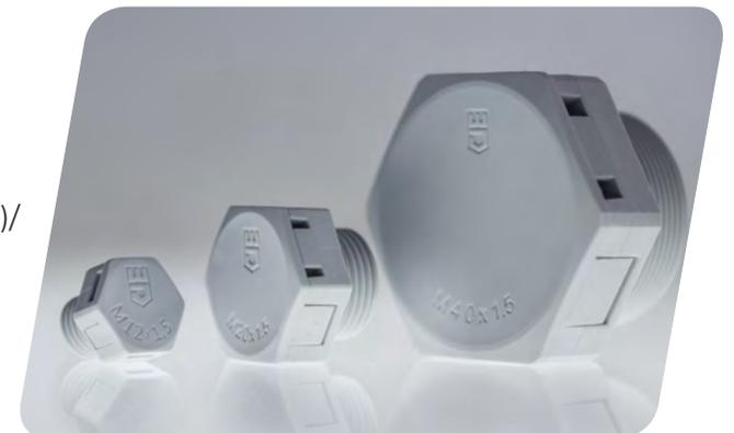
Wasserdicht geprüfte Gehäuse mit hohen Schutzarten IP67 oder IP68 für den Außenbereich sind nicht automatisch gasdicht. Um Unterdruck, hohe Luftfeuchtigkeit und Kondensatbildung im Gehäuse zu verhindern, müssen stetiger Druckausgleich und Luftwechsel stattfinden. Diese Funktion lässt sich schnell und einfach mit dem Druckausgleichselement JDAE realisieren.
