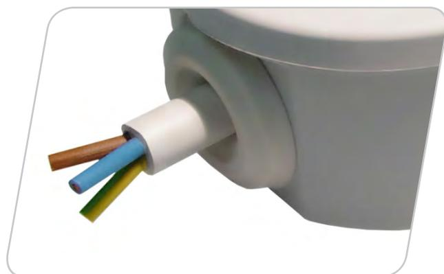
KLICKSEAL® ist eine 2K-Dichtungsdurchführung mit integriertem Rückhalt für das Kabel. Mit ihrer patentierten "Klik-Fix" Konstruktion kann man KLIKSEAL einfach in die Gehäuseöffnung klicken, ganz ohne Werkzeug. Die Durchführung hat eine "pop-out" Membran, welche erst bei der Installation mit der Leitung durchgestossen wird. Bis dahin ist die Dichtung komplett geschlossen, so daß das Gehäuse beim Transport vor Staub und Feuchtigkeit bestens geschützt ist.
