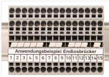
Mit dem Endlosbrücker der Serie 2002 können in nur einer Brückerspur endlos viele Klennen miteinander verbunden werden. Die zweite Brückerspur bleibt frei.
