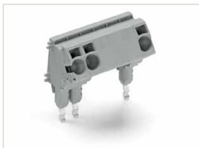
Prüfstecker TOPJOB® S lassen sich direkt in die Leitereinführung stecken und auch ohne Werkzeug wieder herausziehen. Sie eignen sich besonders für Mehrstockklennen, bei denen im eingebauten Zustand der Brückerschacht nicht zugänglich ist. Zwischenrastbare Blindstücke dienen dem Überspringen von nicht zu kontaktierenden Klennen.
