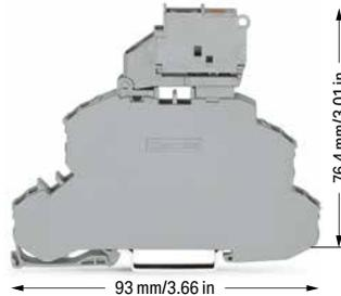
Doppelstock-Sicherungsklemme mit schwenkbarem Sicherungshalter; Durchgangs-/Sicherungsklemme; für G-Sicherungseinsatz 5 x 20 mm; mit Defektanzeige durch LED; grau
