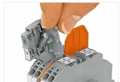
Eine Endplatte für Sicherungsklemmen (hier 2002-1092, orange) dient als zusätzlicher Schutz vor dem Öffnen des Sicherungshalters. Das Auswechseln der Sicherung kann erst erfolgen, nachdem der Sicherungshalter vom Stromkreis getrennt wurde.
