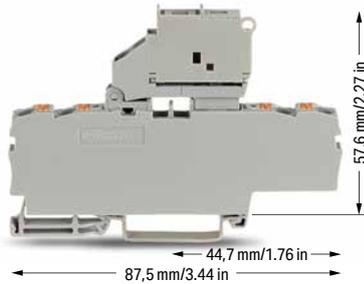
4-Leiter-Sicherungsklemme mit schwenkbarem Sicherungshalter; mit Drücker; für G-Sicherungseinsatz 5 x 20 mm; ohne Defektanzeige
