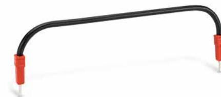
Steckbarer Leitungsbrücker; isoliert; L = 110 mm; Leitungsquerschnitt 1,5 mm<sup>2</sup>; für Reihenklennen der Serien 2001, 2002, 2003 2022, 2201 und 2202
