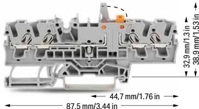
4-Leiter-Trenn- und Messklemme; mit mechanischer Verriegelung; mit Prüfmöglichkeit; Trennmesserhalter orange
