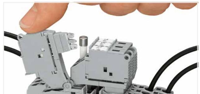
Sicherungshalter in Endposition ausschwenken. Sicherungsklemmen für G-Feinsicherungen sind in den Nennquerschnitten 2,5 mm<sup>2</sup> und 6 mm<sup>2</sup> erhältlich.
