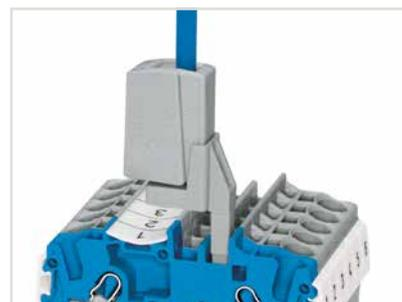
Der Prüfabgriff (2009-182) passt für die Serien 2000 bis 2016, für den werkzeuglosen Anschluss individueller Prüflitungen bis 2,5 mm<sup>2</sup>.
