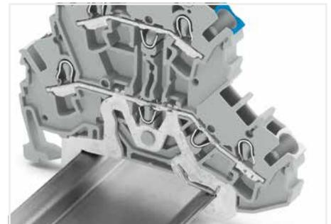
Die Schutzleiter- oder Schirmleiterklemmen haben einen Kontaktfuß mit automatischer Kontaktierung zur Trag-/Sammelschiene.
