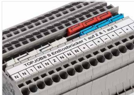
Mit dem Querbrücker für Endlosbrückung, von 1 auf 3, kann in einer Brückerspur endlos jede zweite Klemme gebrückt werden. Plus- und Minuspotentiale können so beispielweise aneinander vorbeigeführt werden.
