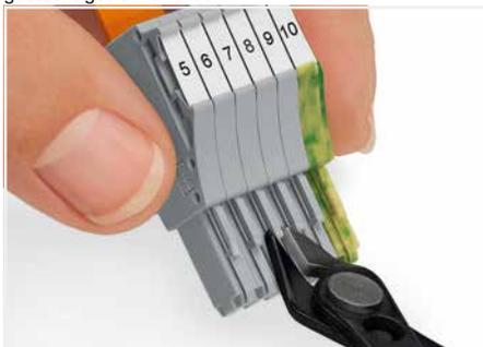
Federleiste kodieren, gewünschte Kodiernase mittels geeignetem Werkzeug von der Federleiste abtrennen.
