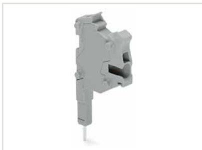
Steckverbindermodule mit Push-in CAGE CLAMP®-Anschluss, für Leiter des gleichen Querschnittsbereiches wie die jeweilige Reihenklemme, bieten eine zusätzliche Anschlussmöglichkeit für bis zu 32 A. Gleichzeitig können Steckverbinder als Prüfstecker dienen.
