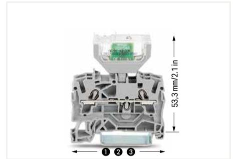
Maß für Durchgangsklemmen mit steckbarem LED-Baustein:
