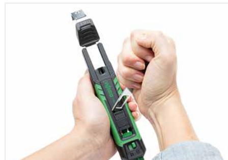
Zum Austausch des Wechselbügels den neuen Wechselbügel als Betätigungswerkzeug verwenden und den Wechselbügel nach oben rausziehen.
