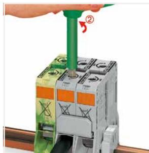
Durch weiteren kurzen Linksdreh ② wird die Sperre aufgehoben und der Innensechskantschlüssel ohne Kraft zurückgeführt. Der Leiter ist sicher geklemmt.
