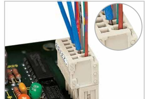
Prüfen mit Prüfstift Ø 1 mm, Bestellnr. 735-500
