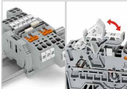
Zwei Brückerspuren positionsgleich mit anderen Klemmen der Serie 2002; wahlweises Brücken vor oder nach dem Trennmesser, je nach Einspeiserichtung; zusätzliche Beschriftungsmöglichkeit über schwenkbare Beschriftungsträger
