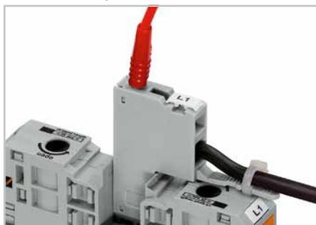
Der Potentialabgriff wird im Brückerschlitze montiert. Er kann mit einer Zugenlastungsplatte versehen werden und bietet eine Prüfmöglichkeit für Prüfstecker Ø 2 mm.
