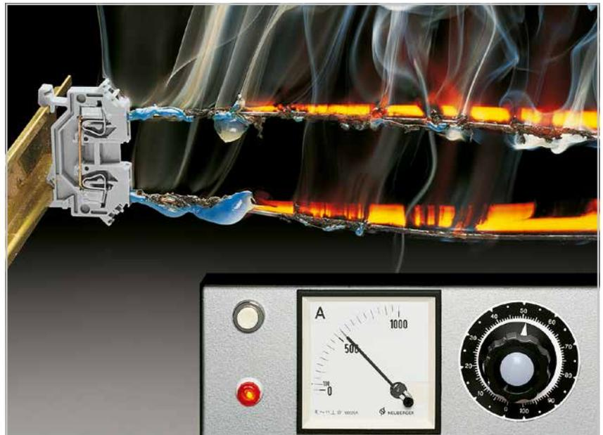
Praxisferne Prüfung an einer CAGE CLAMP®-Reihenklemme, 4 mm<sup>2</sup>:
