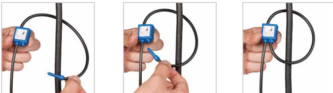
Funktion: Die Rogowski-Spule ist eine geschlossene Luftspule, mit einem teilbaren Spulenkörper und mit einem nichtmagnetischen Kern. Sie wird um einen Leiter oder eine Stromschiene herum platziert. Der durch den Leiter fließende Wechselstrom erzeugt ein Magnetfeld, welches in der Rogowski-Spule eine Spannung induziert. Dieses Messverfahren gewährleistet eine galvanische Trennung zwischen dem primären Stromkreis (Leistungsfluss) und dem sekundären Stromkreis (Messung).
