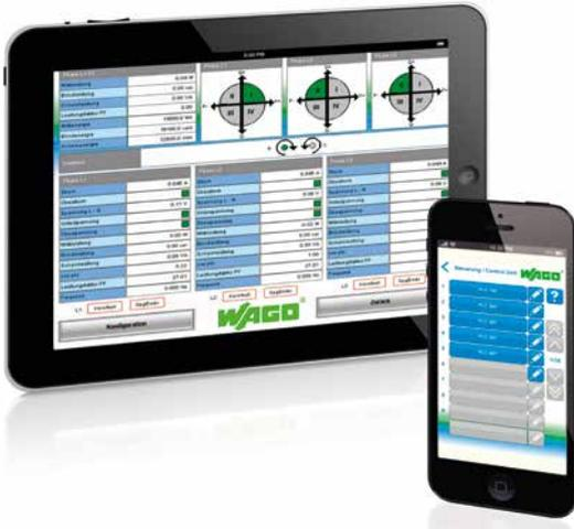
Mit der WebVisu-App lassen sich Web-Seiten der CODESYS-2-WebVisu auf mobilen Endgeräten aufrufen. Die zu überwachende Anlage oder Maschine kann damit jederzeit mobil bedient und beobachtet werden. Bis zu 100 Steuerungen können für einen direkten und schnellen Zugriff per URL vordefiniert werden.
