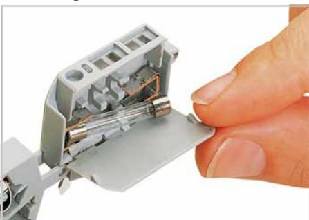
Die Sicherung wird beim Abklappen des Verschlussdeckels automatisch aus dem Sicherungshalter herausgehobelt.
