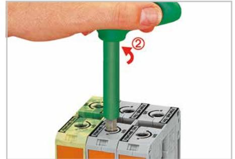
Durch weiteren kurzen Linksdreh ② wird die Sperre aufgehoben und der Innensechskantschlüssel ohne Kraft zurückgeführt. Der Leiter ist sicher geklemmt.
