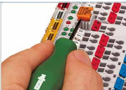
Rastposition zum „Spannungsfreischalten“ z. B. während der Inbetriebnahmephase
