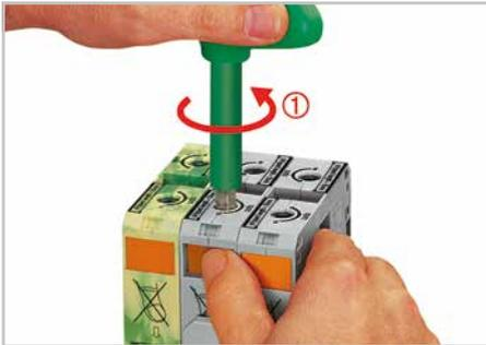
Innensechskantschlüssel bzw. Schraubendreher gegen den Uhrzeigersinn bis zum Anschlag drehen ①, dann die orangefarbene Taste (Arretierfunktion) drücken, Anschlussstelle bleibt geöffnet.
