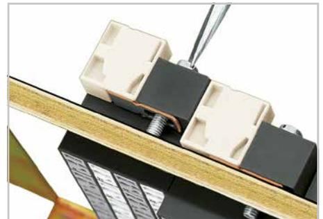
Montage einer Rangierwabe mit angerastetem Zusatzmodul; direkte Kontaktierung zum Montagerahmen
