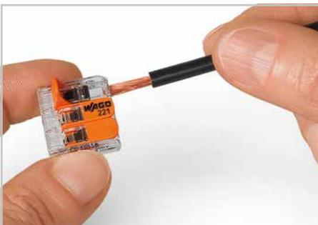
Leiter anschließen: Klemmstelle durch Betätigungshebel öffnen und Leiter einführen. Anschließend Hebel in Ruhelage zurückführen.
