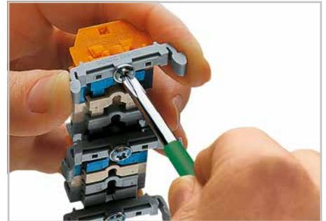
Klemmleiste mit Befestigungsflanschen, Anschrauben des Montagefußes 209-123 (Der Abstand der Montagefüße zueinander unter einer Klemmleiste soll ca. 35 ... 40 mm betragen.)
