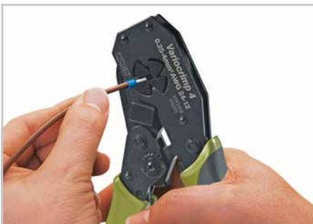
Leiter mit aufgesteckter Aderendhülse in die Crimp-Station einführen und Griffe zusammendrücken, bis die Zwangssperre gegen vorzeitiges Öffnen überwunden ist.
