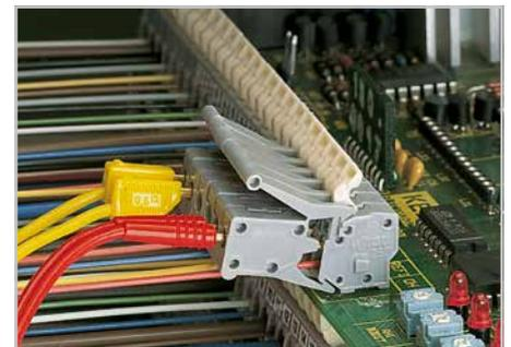
Leiter anschließen/lösen – Serie 257
