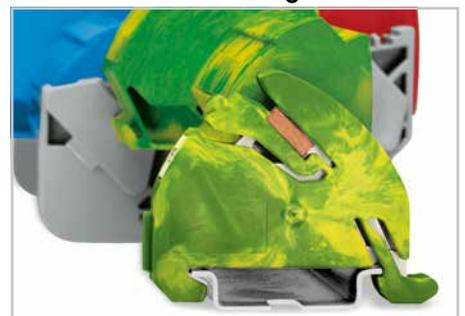
Er bietet eine Rastaufnahme für die Sammelschiene (10 x 3) mm. Die Montage auf die Tragschiene DIN 35 erfolgt komfortabel durch einfaches Aufschieben. Dabei wird automatisch der Kontakt zwischen der Sammelschiene und der Tragschiene hergestellt. Die Sammelschienenposition entspricht der mittleren Position des isolierten Sammelschieneenträgers.
