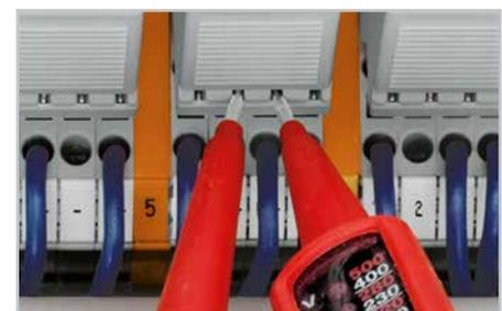
Funktionsprüfung an berührungsgeschützten Tipprüfkontakten
