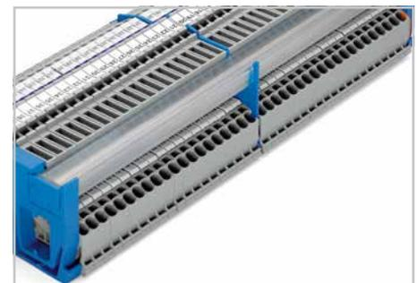
Der schmale Sammelschienträger dient als zusätzliche Stütze der Sammelschiene bei langen Klemmenreihen (alle 200 mm).
