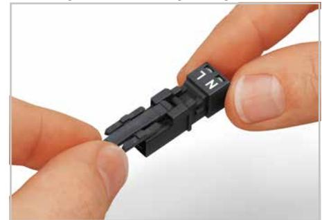
Verriegelungsklinken sind an allen fest zu installierenden Produkten (Snap-In-Varianten für Leuchten bzw. Geräte, alle Verteilervarianten, alle Leiterplattenvarianten) werkseitig montiert, sodass immer eine Verriegelung mit den zu steckenden Buchsen bzw. Steckern stattfindet. Eine zusätzliche Verriegelungsklinke ist nur bei einer „fliegenden Verbindung“ (Buchse/Stecker) erforderlich.
