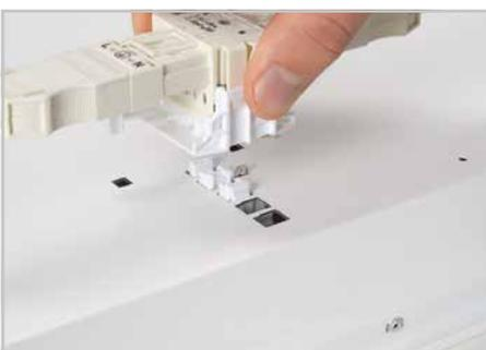
Steckverbinder in den beiden quadratischen Aussparungen positionieren.
