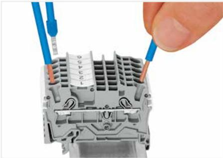
Direkt Stecken – Eindrängige Leiter lassen sich bis zu einem Querschnitt über und mindestens zwei Querschnitte unter dem Nennquerschnitt direkt stecken – ohne Werkzeug.
