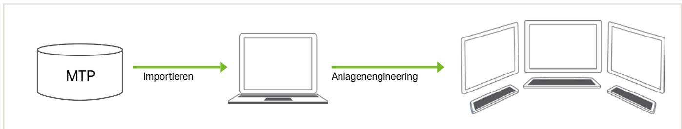
WAGO bietet ein komplettes Automatisierungssystem bestehend aus einem modularen Steuerungssystem mit I/O-Modulen für nahezu jedes Signal, ein Touch Panel-Portfolio sowie ein dazu passendes Engineeringssystem an. Mit der „WAGO Library MTP“ ist es möglich, Module zu automatisieren, und mit *e!COCKPIT* sowie einem zusätzlichen Add-on auf Knopfdruck die MTP-Modulbeschreibung zu erzeugen, die sich auf einfache Art und Weise in verschiedensten Visualisierungs- und Leitsysteme integrieren lässt.
