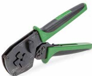
Crimp-Zange Variocrimp 16; für Aderendhülsen mit und ohne Kunststoffkragen; Crimp-Bereich 6 mm<sup>2</sup> (10 AWG), 10 mm<sup>2</sup> (8 AWG) und 16 mm<sup>2</sup> (6 AWG)
