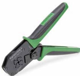
Crimp-Zange Variocrimp 4; für Aderendhülsen mit und ohne Kunststoffkragen; Crimp-Bereich 0,25 ... 4 mm<sup>2</sup> (24 ... 12 AWG)
