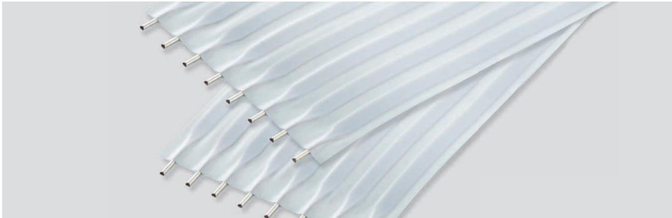
**PANTA® FIX POWER JUMPER** sind flexible Flachleiterverbinder, speziell für Applikationen mit Strombelastbarkeit bis 12 Ampere. Durch die PANTA® Rund-Flach-Rund Technologie werden die Kupferleitungen im Bereich der Isolation definiert flachgewalzt und garantieren somit höchste Anforderungen an Vibrations- und Biegebeständigkeit. Der fließende und kerbfreie Übergang von rund zu flach garantiert eine bruch sichere Anschlussstelle.
